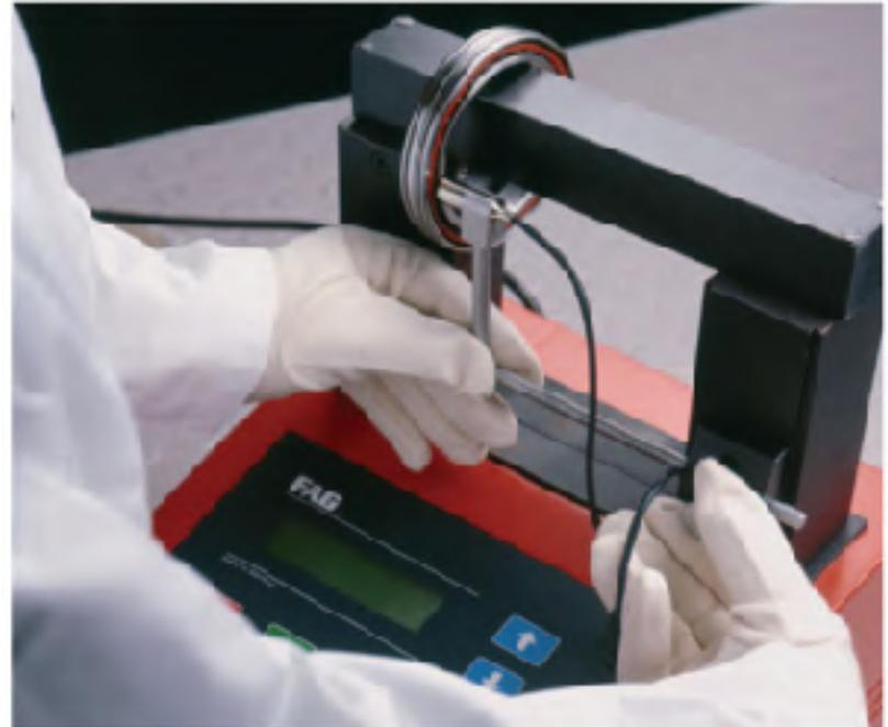
3: Calentamiento de un rodamiento para husillos mediante un dispositivo de calentamiento por inducción
