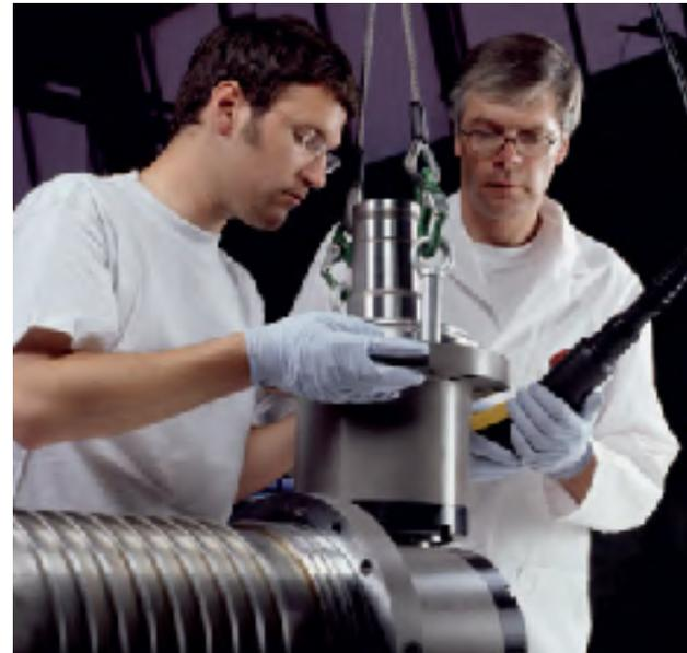
En el montaje del rodamiento sobre el eje o en el alojamiento, en ningún caso deben conducirse las fuerzas de montaje a través de los elementos rodantes.
